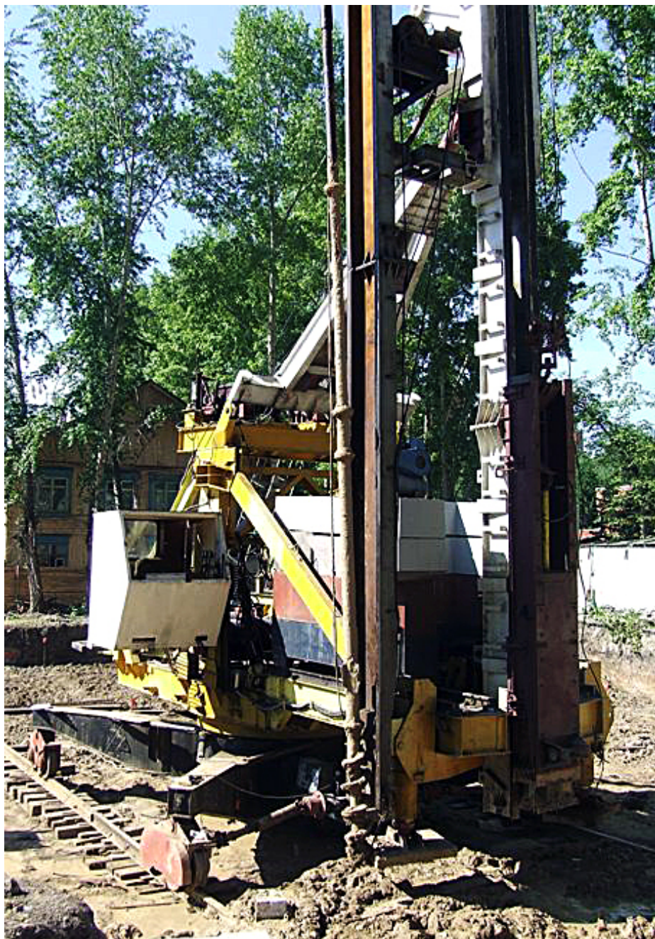
Рис.1. Общий вид сваевдавливача (СВУ) на строительной площадке в г. Томске (2012 г.)
