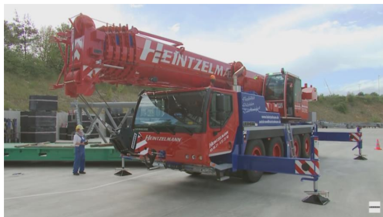
Рис. 4. Установка выносных опор крана и его горизонтирование
